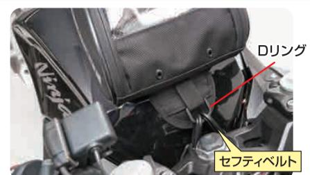
2 オートバイのステアリングヘッドに、図のようにセフティベルトをまわし、緩みのないように長さを調節して、フックをもう片方のDリングに固定します。
